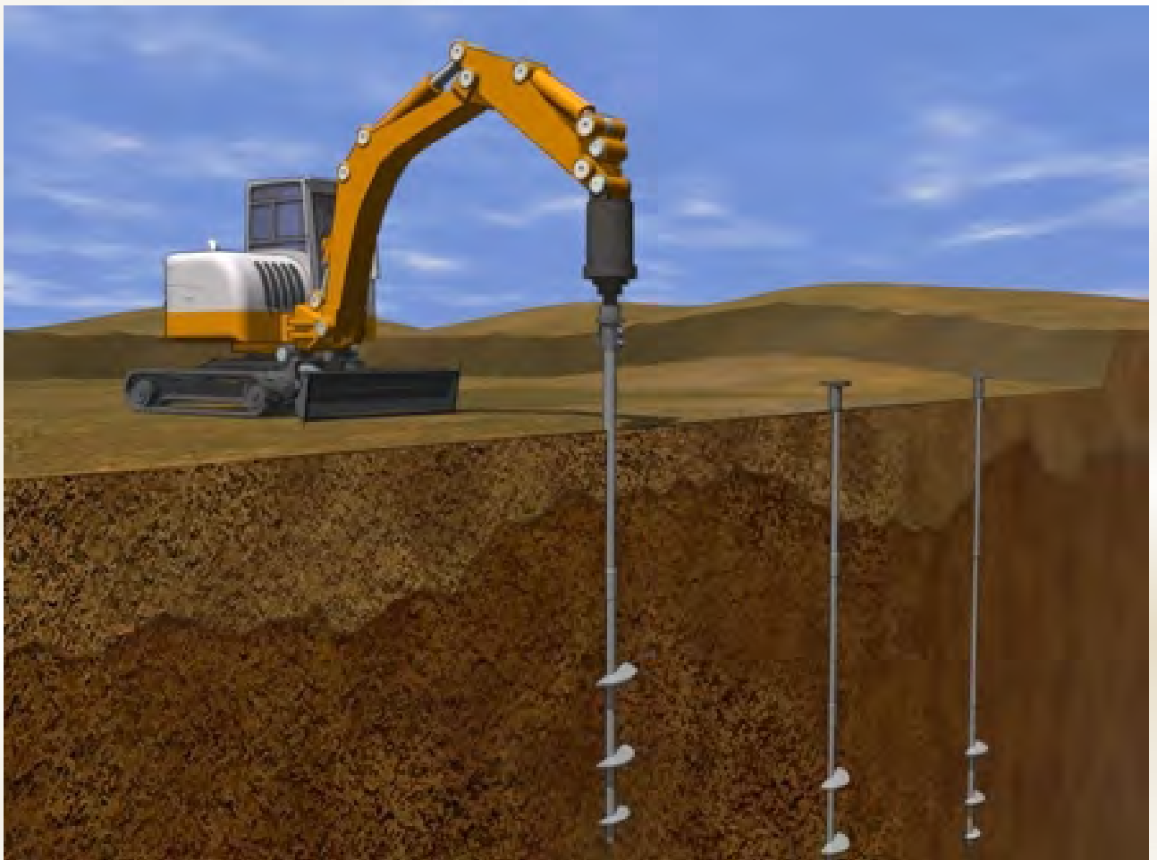
Desenho esquemático da cravação das estacas helicoidais.
